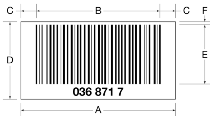
Obrázek 2 Rozměry čárového kódu
