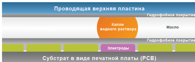
Рисунок 1 Плата библиотеки в разрезе — вид сбоку
