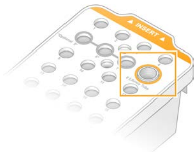
Рисунок 10 Пробирка с библиотекой без колпачка загружена в положение № 8
