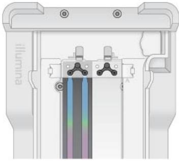
6. 将 NovaSeq Xp 歧管孔朝上装到流动槽入口端上方。确保 NovaSeq Xp 歧管臂已牢固地放入固定架切口。
