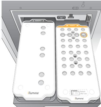
5. Schieben Sie die Schublade in den Kühler und schließen Sie die Reagenzienkühlertür. Die Sensoren und die RFIDs werden überprüft. Die IDs für das Bibliotheksröhrchen und die zwei Kartuschen werden auf dem Bildschirm angezeigt.
