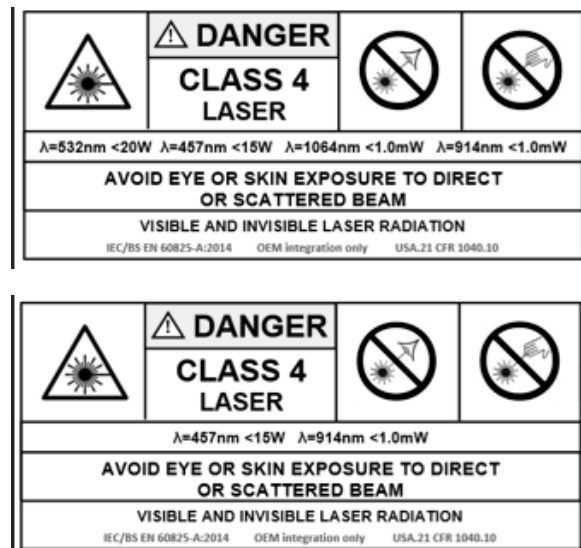
Фигура 1 Предупреждения за лазера от клас 4
