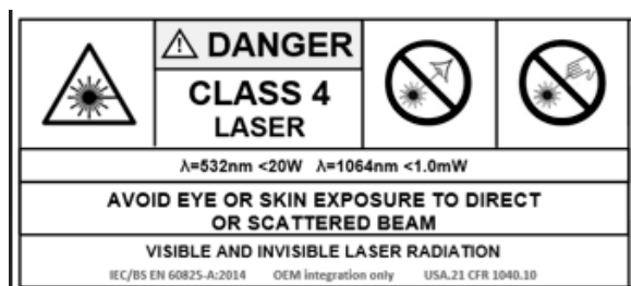
Εικόνα 2 Προειδοποιητική ετικέτα λέιζερ της Illumina για τον μηχανικό επιτόπιου σέρβις (FSE)
