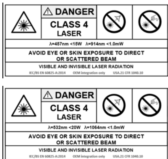
Рисунок 2 Предупреждающая этикетка для лазерного оборудования от инженера по сервисному обслуживанию (FSE) компании Illumina
