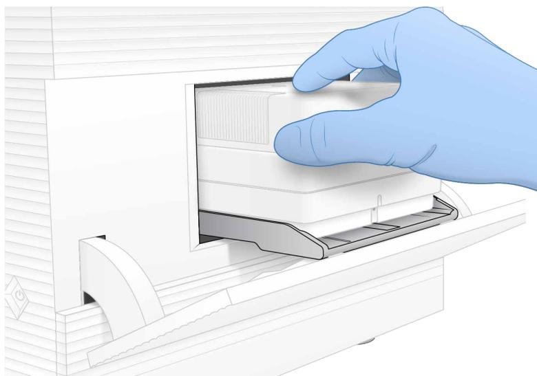
9. **[Load]** を選択すると、再使用可能テストカートリッジをロードし、ドアが閉まります。
