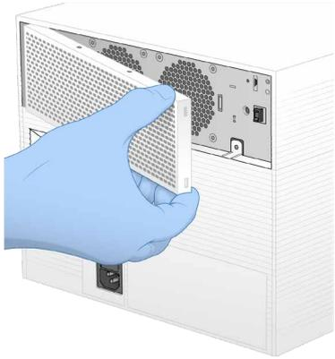
4. エアフィルターをパネルの中央から取り外し、処分します。
