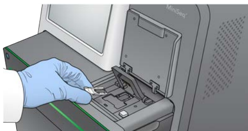
Figura 12 Posizionamento della cella a flusso sul piano portacelle
