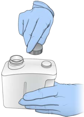
Figura 22 Sigillo del flacone dei reagenti usati
