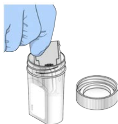
Figura 9 Rimozione della cella a flusso
