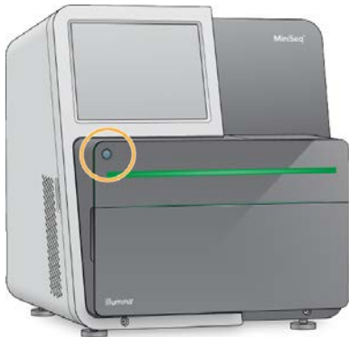
Afbeelding 8 De aan-uitknop op de voorkant van het instrument
