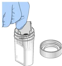
Afbeelding 9 De stroomcel verwijderen
