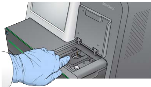
Afbeelding 19 De stroomcelvergrendeling sluiten
