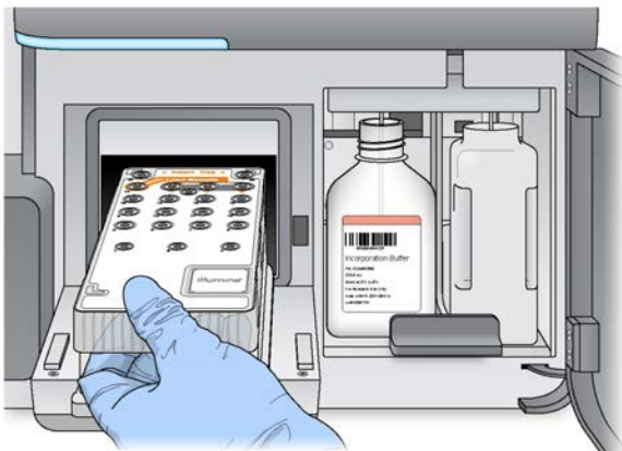
Obrázek 14 Vložení kazety reagensů
