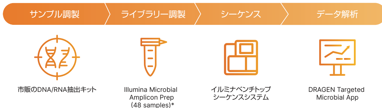
図2: Illumina Microbial Amplicon Prep ワークフロー: 効率化されたワークフローでは、Illumina Microbial Amplicon Prep キットを使用して微生物ライブラリーを調製し、イルミナベンチトップシーケンスシステムでシーケンスし、DRAGEN Targeted Microbial App で検出、バリエーションコールおよび系統タイプングを解析します。* キットにはライブラリー調製用のインデックスが含まれています。プライマーオリゴは別途購入してください。
