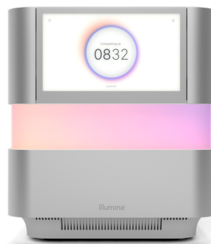
Figure 2 : Systèmes de séquençage NextSeq 1000 et NextSeq 2000 : les systèmes NextSeq 1000 et NextSeq 2000 exploitent la chimie XLEAP-SBS et intègrent l'analyse secondaire pour rationaliser les flux de travail de séquençage.
