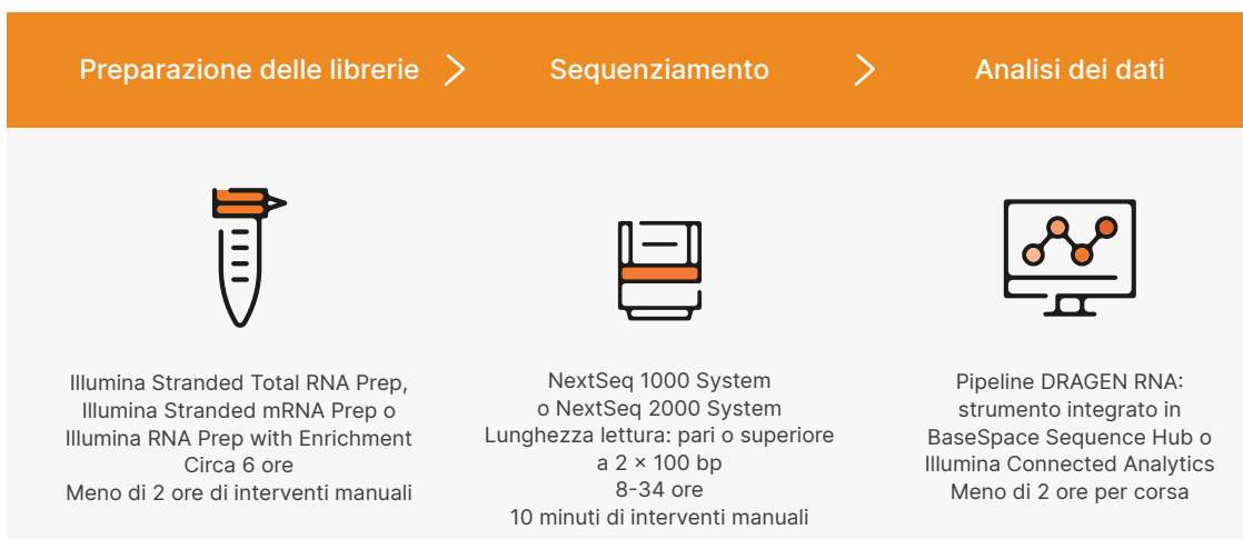
Figura 1: flusso di lavoro per l'RNA-Seq con NextSeq 1000 e NextSeq 2000. NextSeq 1000 System e NextSeq 2000 System fanno parte di un flusso di lavoro NGS semplice e integrato che fornisce dati di sequenziamento dell'RNA altamente accurati. Le durate variano in base all'esperimento e al tipo di saggio.
